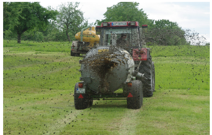
Foto 4: Pendelverteiler (ab 2025 nicht mehr zulässig)
