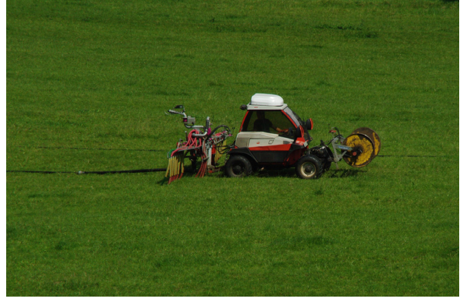
Foto 8: Gülleverschlauchung in Hanglage
