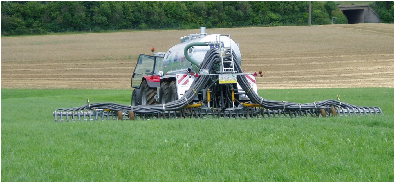
Foto 1: Schleppschuhverteiler ermöglichen bodennahe Gülleausbringung.
