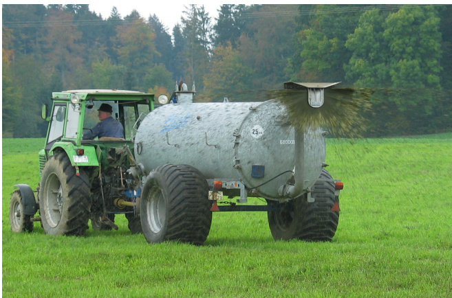
Foto 3: Prallkopfverteiler (ab 2025 nicht mehr zulässig)
