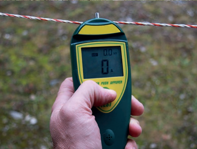
Abbildung 7.13: Ein gutes Messgerät für die Zaunspannung gehört zur Grundausrüstung. Mit ihm kann auch festgestellt werden, in welcher Richtung nach einer Störquelle zu suchen ist.
