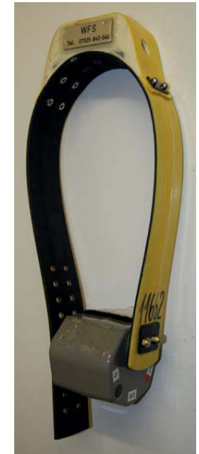
Abbildung 4: GPS-GSM-Senderhalsband der Firma VEC-TRONIC mit Aktivitätssensor und Drop Off.
